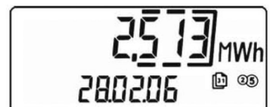
Exempel: månadsvärde värme energi
